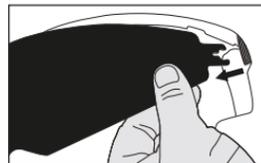
**ATENCIÓN:** ¡LA PANTALLA SÓLO SE PUEDE DESMONTAR O COLOCAR CUANDO ESTÁ EN POSICIÓN COMPLETAMENTE ABIERTA!
